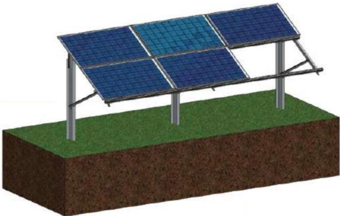
Слика 11. Приказ на монтажната конструкција
