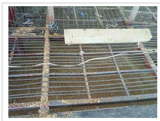
Слика II.1 Подвижна платформа и решетка на бункерот
