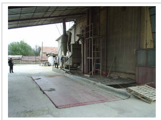
Слика II.1 Подвижна платформа и решетка на бункерот
