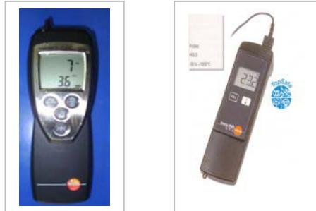
**Слика бр.1 и 2:** testo 512 и testo 925
